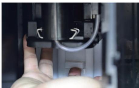
3. Просуньте руку под заварной блок и толкните защитный механизм для разблокирования заварного блока
