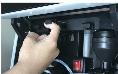
3. Потяните фиксатор до упора на себя
