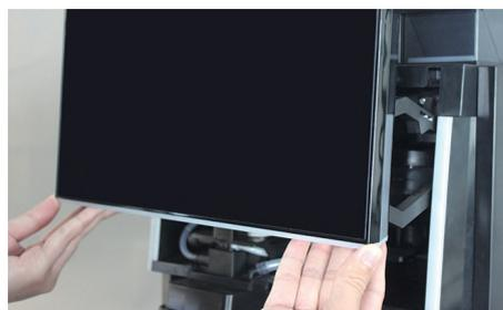
2. Поднимите дисплейную панель
