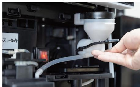
3. Поднимите фиксатор миксера для его разблокировки
