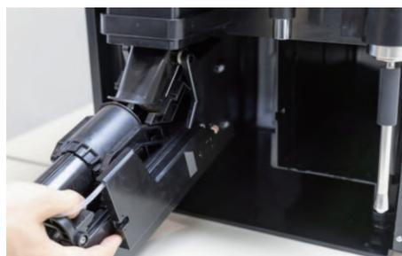
4. Аккуратно извлеките заварной блок, наклонив его на себя и одновременно потяните, как показано на рисунке.
