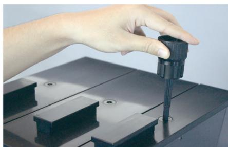
1. Разблокируйте крышку бункера для порошка используя ключ
