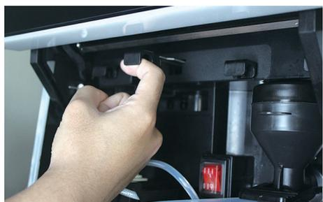
3. Потяните фиксатор до упора на себя
