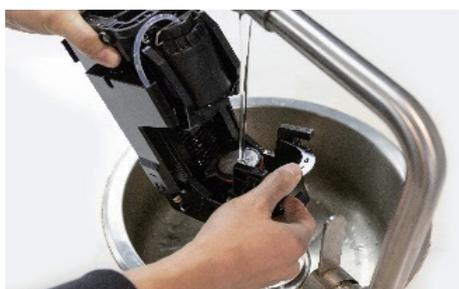
5. Промойте сито заварного блока под проточной водой
