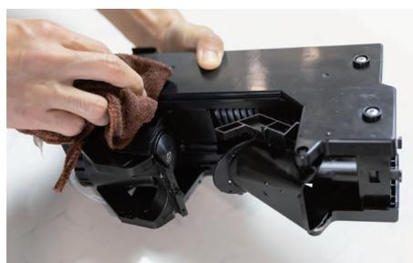
6. Протрите заварной блок сухой тканью и дайте ему полностью высохнуть перед установкой в кофемашину
